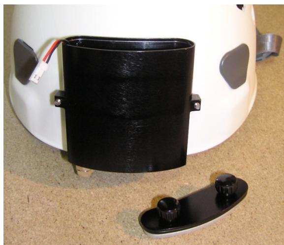
Caixa da bateria montada
