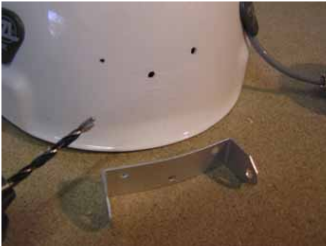
Vorbereitete Bohrungen für den Lampenhalter.
