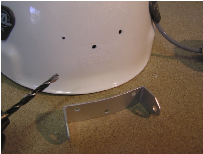
Fori preparati per il supporto della lampada
